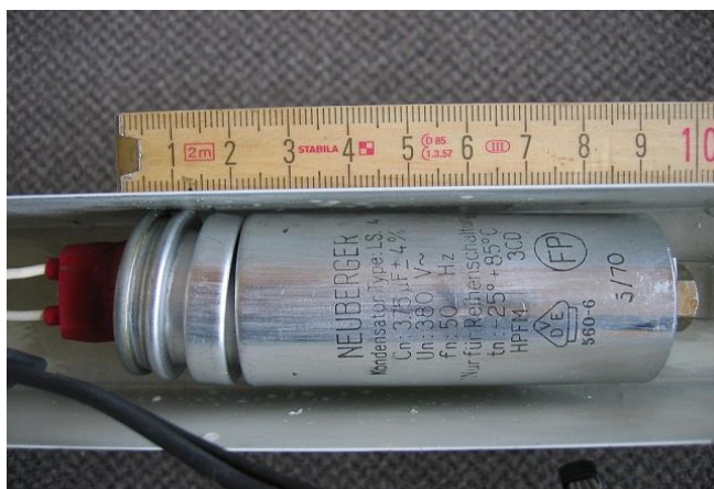
Abb. 5: Kondensatoren: Ein typisches Anwendungsfeld von PCB
